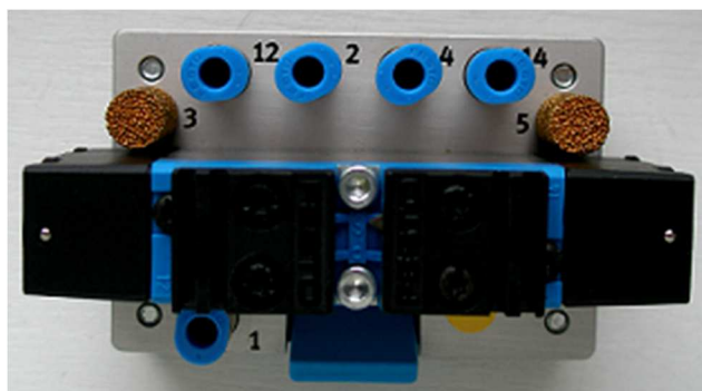
Obrázek dvojčinného rozváděče 5/2 a jeho schematická značka
